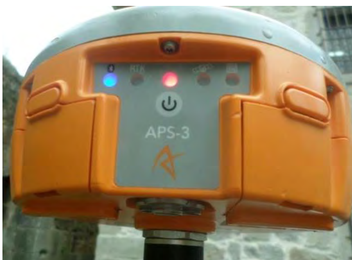
Figura 1.2.22. GPS Altus APS-3, encendidos los pilotos de conexión con un mínimo de 5 satélites.
