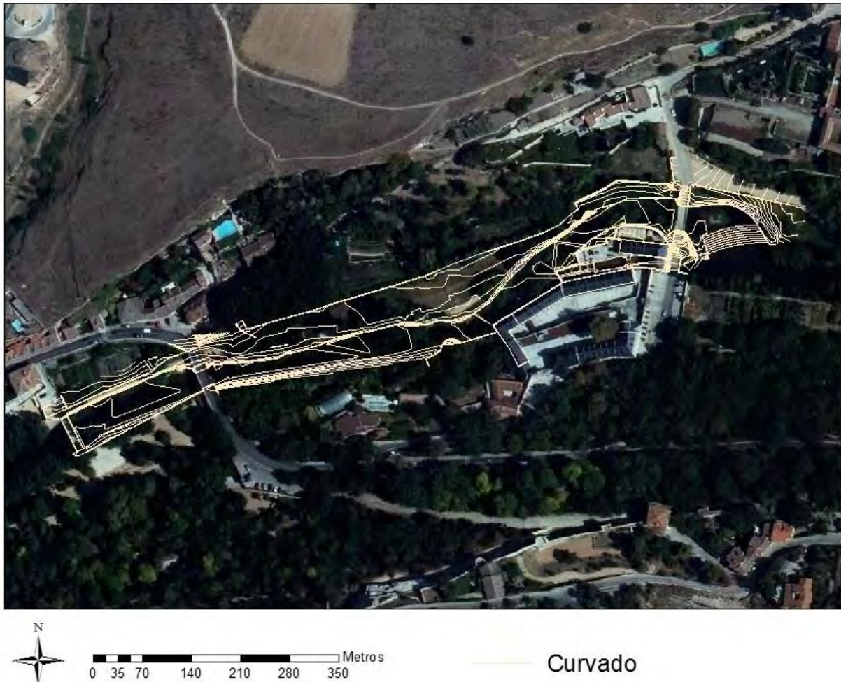
Figura 1.2.24. Curvado: la base del modelo es la topografía generada.
