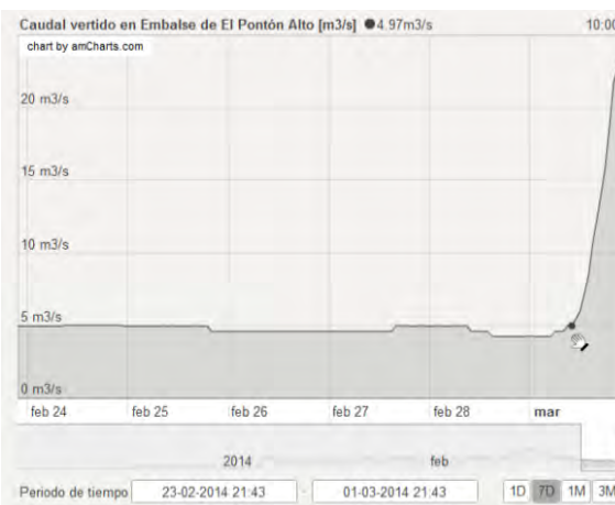
Figura 1.2.13. Hidrograma de la estación del de vertido del embalse del Pontón Alto entre los días 24 de febrero y 1 de marzo de 2014 (fuente: web SAIH Duero, CHD).
