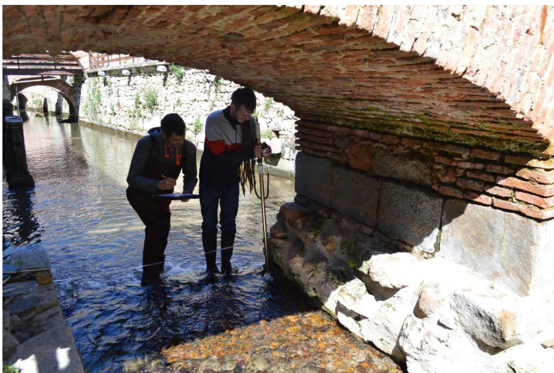
Aforo con micromolinetete en el canal de Herrera
