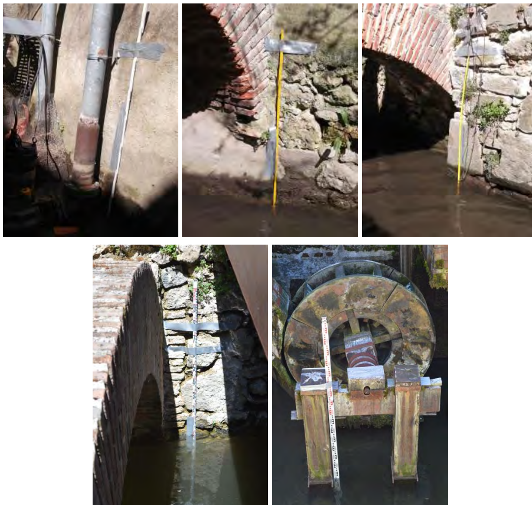
Figura 1.3.13. Puntos de medida 1-2-3-4-5 en el ensayo de llenado y vaciado de los canales.
